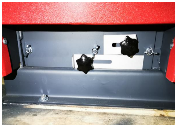
Abbildung 9: Lage der Klappen für die Sekundärluftzufuhr
