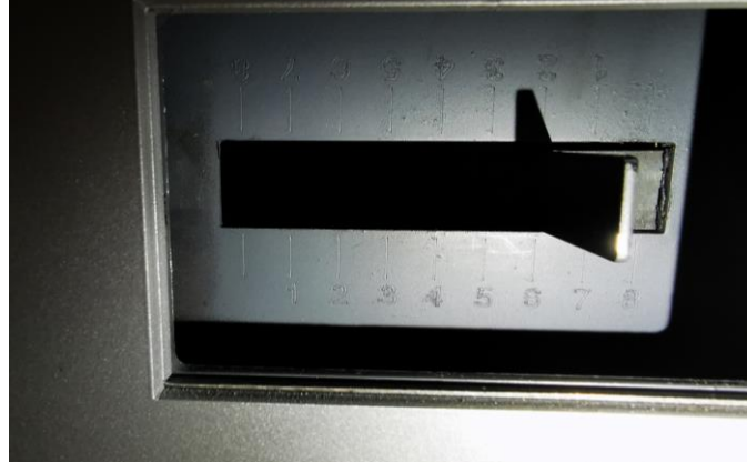
Abbildung 10: Einstellung der Primärluftmenge
