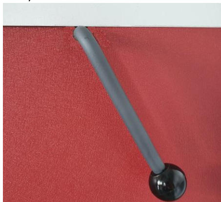
Abbildung 8: Kurzschlussklappenhebel in geschlossener Stellung.
