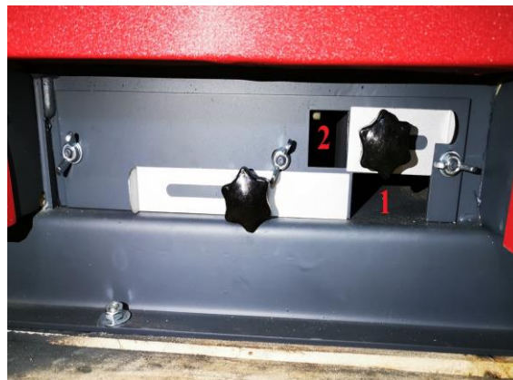
Abbildung 11: Einstellung der Sekundärluftmenge
